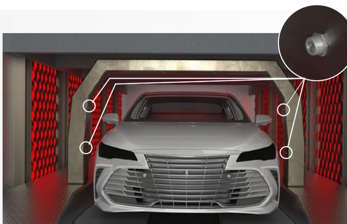
thermoMETER UCIによる車両塗装後の乾燥工程チェック
