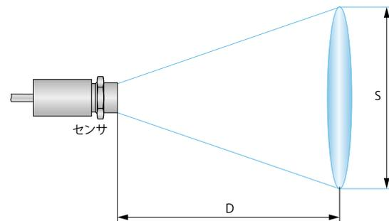
焦点を適切に選択することで、スポットサイズを変更することができます。例えば、CFレンズは極小のスポットを生成できます。一方でSFレンズは、より長い距離で測定ができる大きなスポットを生成します。
