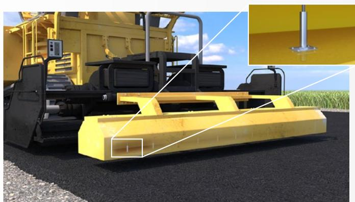
アスファルトフィニッシャに統合されたthermoMETER FIが、敷き均し後のアスファルト温度を測定
