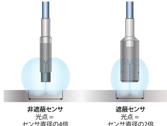
✓ ターゲット直径 = センサ直径の4倍もしくは2倍
