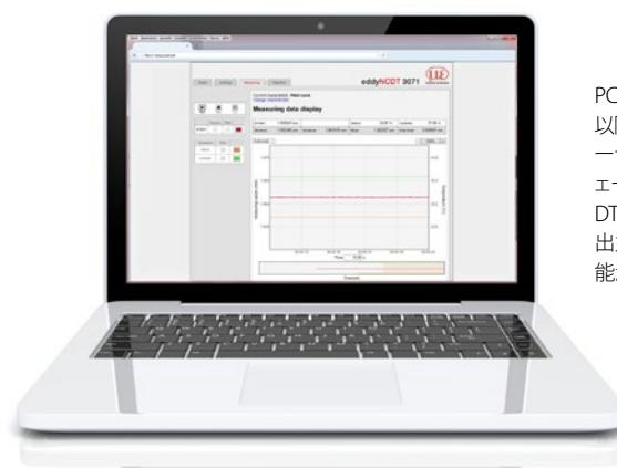
PCをイーサネットインターフェース経由で接続すると、以降のインストール作業を行わずに、センサとコントローラのパラメータ化が可能な最新式ウェブインターフェースを呼び出すことができます。コントローラタイプ DT3071には、5点校正、スイッチング出力および温度出力の設定、複数特性曲線の保存といったその他の機能が搭載されています。
