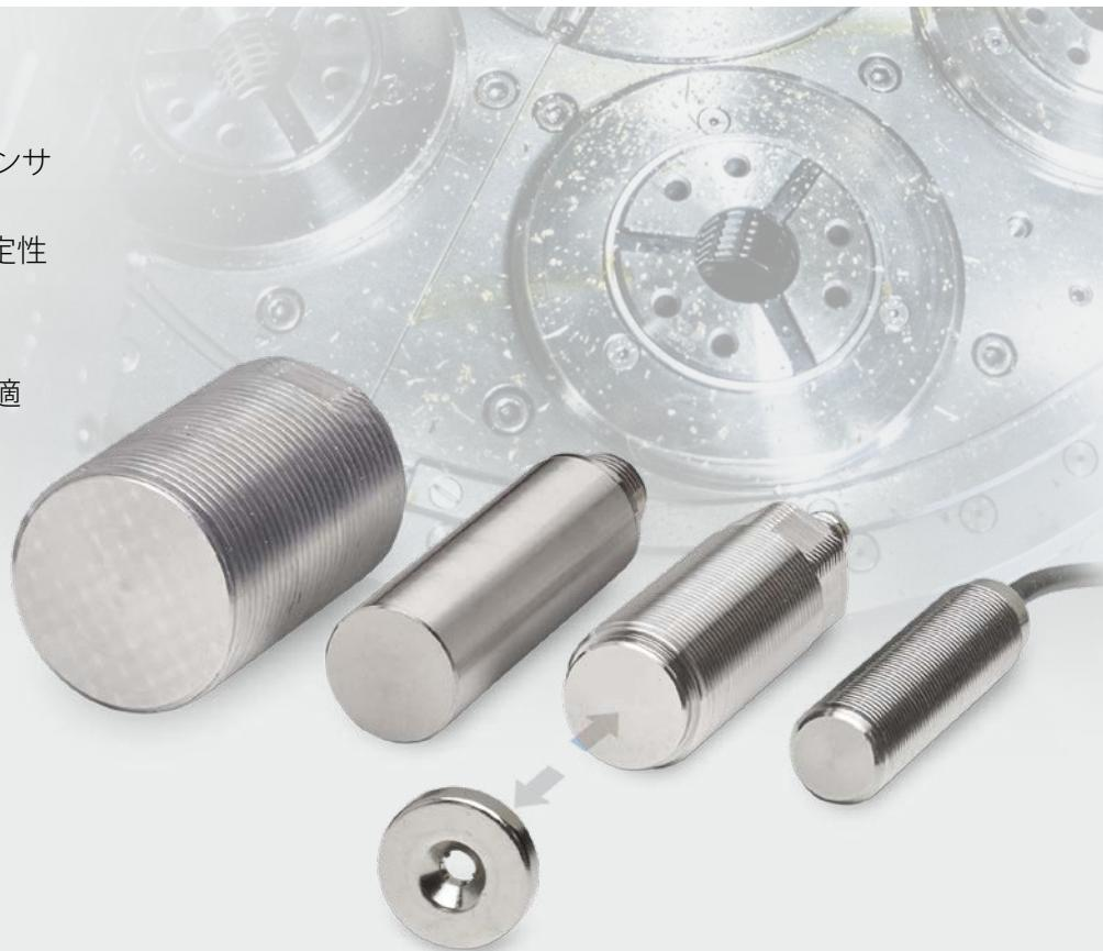
mainSENSOR距離センサには、誘導式センサと磁気センサの長所を組み合わせた革新的な測定原理が採用されています。このセンサは、測定対象物に取り付けられた磁石までの距離を測定し、連続した線形出力信号を出力します。さまざまな強度の磁石によって、20～55 mmの測定範囲にまで対応することができます。測定範囲は磁石の変更によって調整することができます。
