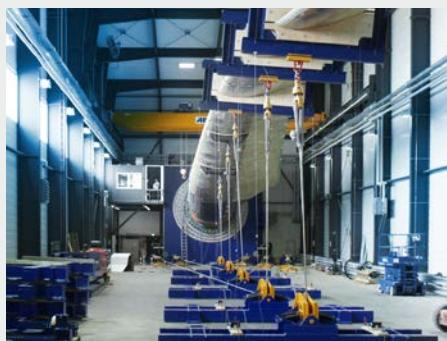
風力発電機の回転翼の変形測定
