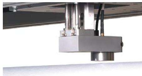
非接触によるフィルムのインライン厚さ測定
