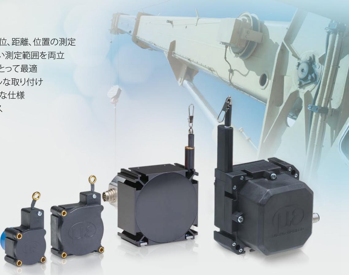
マイクロエプソン社のドローワイヤセンサは、小型サイズでありながらも、長距離の測定を可能にします。ドローワイヤ変位センサは、柔軟性の高いステンレスワイヤを耐久性の高いスプリングモーターによってドラムに巻き付けたケーブルを使用し、部品の直線的な動きを測定します。ケーブルは測定対象物に直接取り付けられ、アクセスが困難な設置スペースでも、滑車を使用してワイヤを誘導することができます。巻き取りドラムは、マルチターンポテンショメータ、インクリメンタルエンコーダまたはアブソリュートエンコーダと共に、軸方向に組込まれています。
