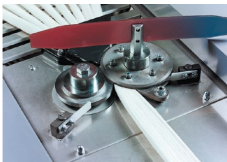
インラインでの糸の太さ測定
