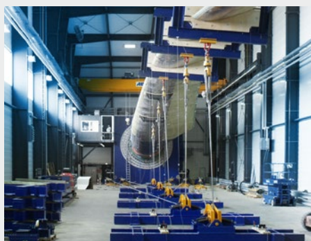
風力発電機の回転翼の変形測定
