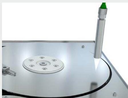
ハードディスクの軸振れ試験
