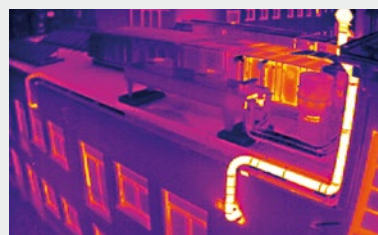
サーモグラフィーによる建物の温度監視
