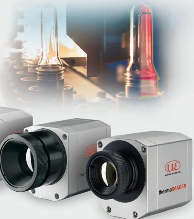
thermoIMAGERは、産業用途のために設計されたサーマルカメラです。これらのカメラの特徴は、コンパクトなデザインと高い費用対効果です。各業界のニーズに合わせて最適化された波長モデルをご用意いたしました。データ転送は、USBインターフェースを通して、カメラからソフトウェアへリアルタイムで実行されます。付属の高性能なプロセス・解析ソフトウェアによって、最大128 Hzでの温度画像を取得することができます。これらのデータを画像ファイルや動画ファイルに保存し、カメラを使用せず後でオフライン状態で閲覧・評価に用いることができます。さらに、このソフトウェアはランタイムアプリケーションとして使用でき、環境を個別にプログラミングし、設定することができます(複数のモニタリングウィンドウ、アラーム、ホットスポット特定、ラインプロファイルなど)。高度なインターフェースコンセプトは、ネットワークや自動化システムへの統合も可能にします。
