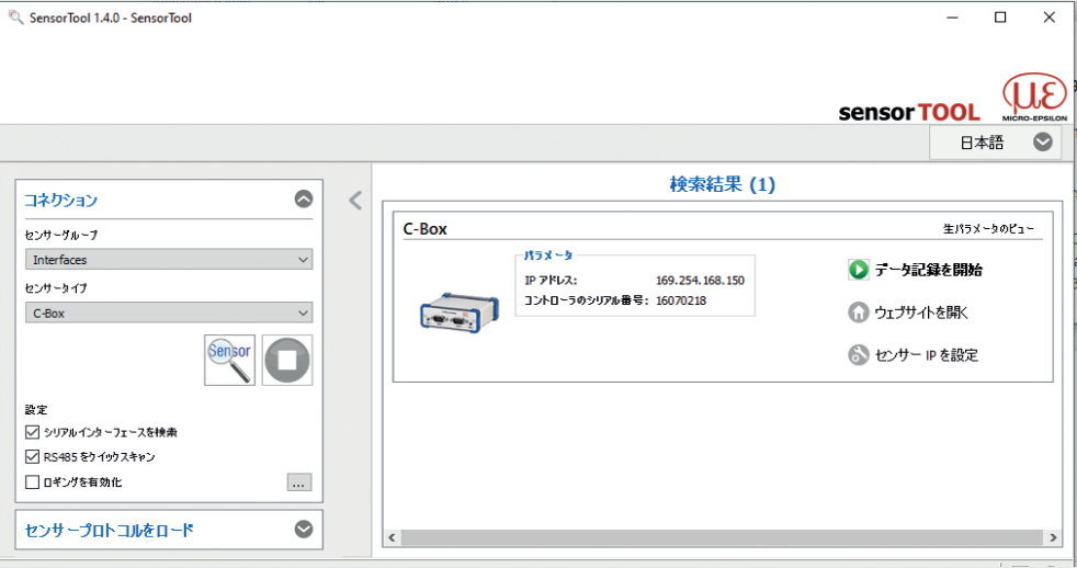
図 7 センサーを検索するためのプログラム sensorTOOL
