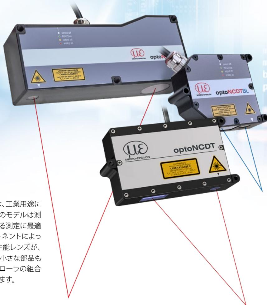
optoNCDT 1910、1710、1750シリーズのレーザーセンサは、工業用途における高速な精密測定向けに設計されています。これらのモデルは測定が困難な表面に使用されており、長い距離を必要とする測定に最適です。革新的な評価アルゴリズムと改良されたコンポーネントによって、高い精度とダイナミクスを実現します。センサの高性能レンズが、測定対象物上に小さなスポットを投影するため、非常に小さな部品も確実に捕捉できます。ピグテールケーブルと内蔵コントローラの組合せにより、センサの設置作業の手間が最低限に抑えられます。
