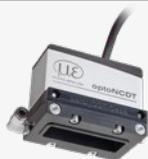
センサに取り付けるだけのコンパクトな保護ハウジング。この保護ハウジングは、保護ウィンドウをクリーニングするためのエアバージ機能を備えており、同時にセンサの冷却も行います。
