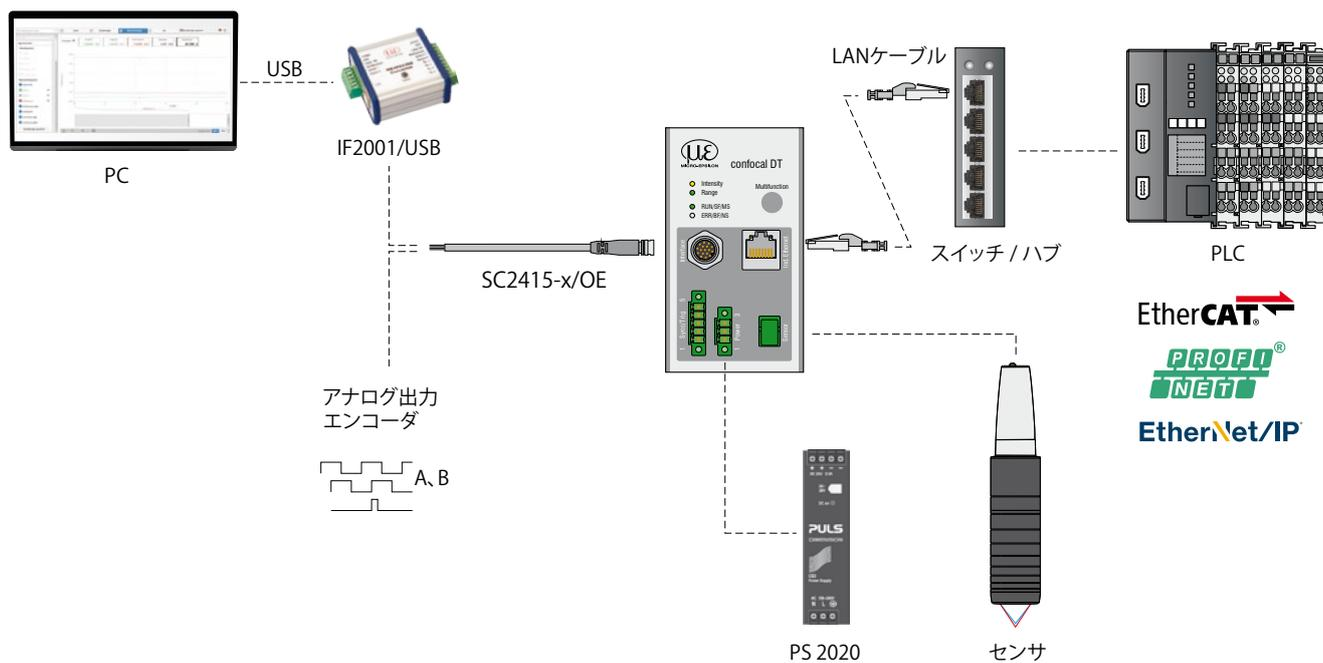
測定システム confocalDTの構成:
