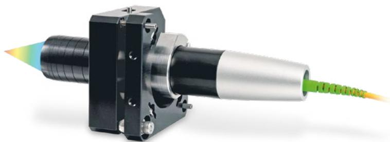
傾斜角度が小さい高分解能センサでは特に、直交固定が重要となります。取付アダプタ JMA-xxの簡単な調整メカニズムによって、センサを測定対象物に対して微調整できるようになります。これによって、わずかな取り付け誤差や測定対象物の傾斜を補正することができます。
