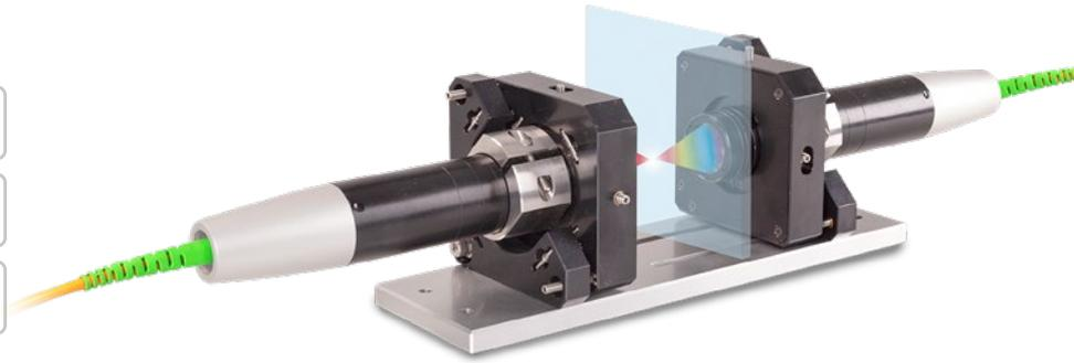
取付アダプタ JMA-Thicknessが、両面厚さ測定時における測定点同士的位置調整をサポートします。このようにして測定点を完全に同じように配置し、センサを光学軸上にぴったりと位置させることができます。これによって、測定のずれが防止され、最大限の精度で信頼性の高い測定結果を得ることができるようになります。
