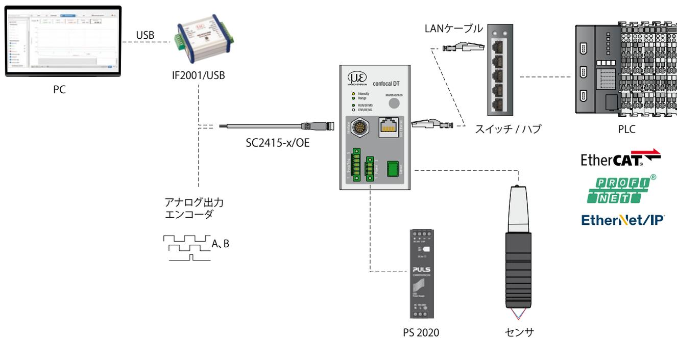
測定システム confocalDTの構成:
