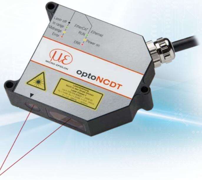
三角測量式レーザセンサのハイエンドモデル、optoNCDT 2300の設定可能な最高測定レートは49.14 kHzです。全エレクトロニクスが、コンパクトなセンサに内蔵されていますが、これは、このセンサクラスでは、世界的にユニークです。高精度のレーザセンサは、振動の監視や難しい表面での測定など、特に高速な用途において使用されます。拡散反射する表面に使用されるこのセンサは、特別な調整を行うことで、直接反射面にも使用することができます。
