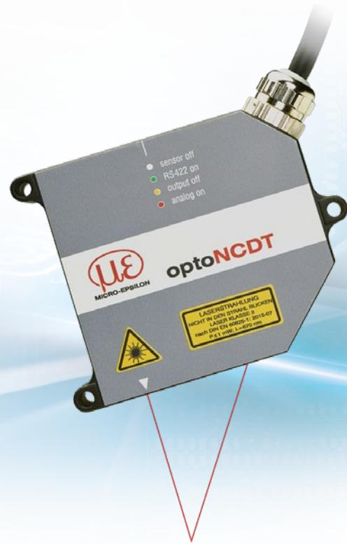
optoNCDT 1750DRセンサは、反射率の高い測定対象物の測定用に設計されており、反射率の高いプラスチック、ミラーガラス、または研磨された金属の距離測定に使用されています。傾いたセンサによってレーザの入射角および反射角が等しくなっています。このセンサは、直接反射した放射線の強度を補正することで、高い信号安定性を実現しています。
