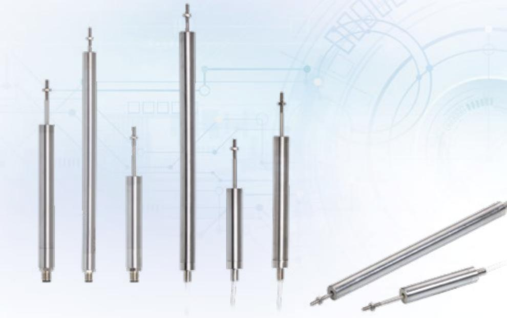
La configuration spécifique des capteurs de déplacement linéaires de la série LDR se distingue par une conception de forme réduite et compacte de faible diamètre. Seuls trois raccords sont nécessaires à la connexion du capteur. Leur forme compacte et leur diamètre réduit permettent de les monter dans des espaces restreints.
