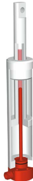
Série EDS : Montage dans un vérin hydraulique
