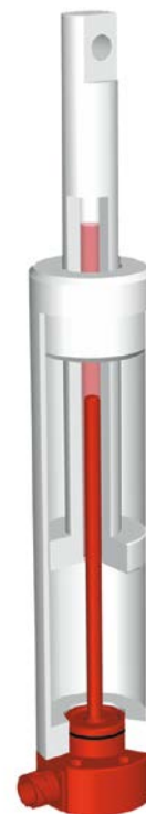
Serie EDS: Einbau in einem Hydraulikzylinder
