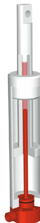
Serie EDS: Einbau in einem Hydraulikzylinder
