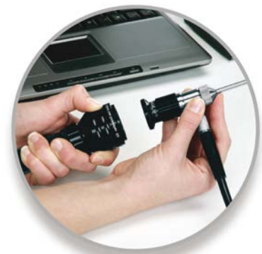
Anschluss Kamera mit Objektiv an ein Endoskop
