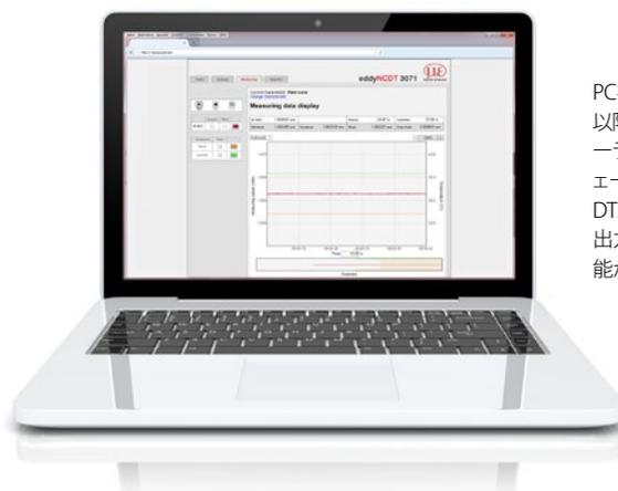
PCをイーサネットインターフェース経由で接続すると、以降のインストール作業を行わずに、センサとコントローラのパラメータ化が可能な最新式ウェブインターフェースを呼び出すことができます。コントローラタイプDT3071には、5点校正、スイッチング出力および温度出力の設定、複数特性曲線の保存といったその他の機能が搭載されています。
