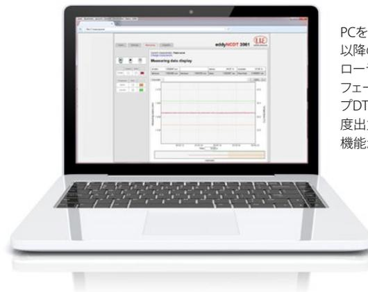
PCをイーサネットインターフェース経由で接続すると、以降のインストール作業を行わずに、センサとコントローラのパラメータ化が可能な最新式ウェブインターフェースを呼び出すことができます。コントローラタイプDT3061には、5点校正、スイッチング出力および温度出力の設定、複数特性曲線の保存といったその他の機能が搭載されています。
