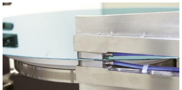
2台の静電容量式センサによるウェハー厚さ測定
